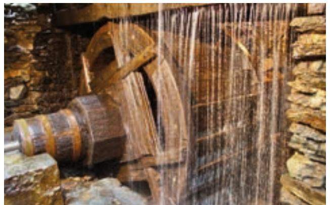
*Das Wasserrad zum Antrieb der Hammerachse
