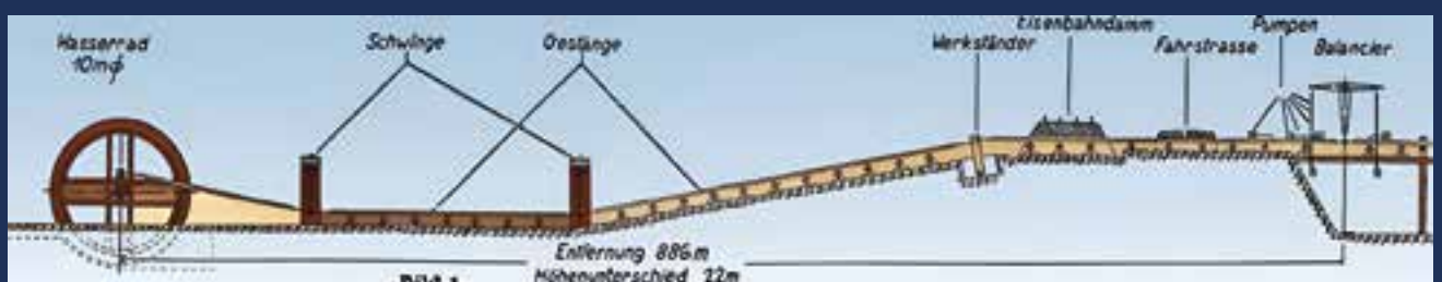
Schwalheimer Feldgestänge: Das Feldgestänge diente dazu, die Kraft der Antriebsmaschine über größere Entfernungen bis zu den Kunstsätzen des Schachtgestänges zu leiten. Dies war dann erforderlich, wenn die Antriebsmaschine nicht über oder unmittelbar neben dem Schacht positioniert werden konnte.
