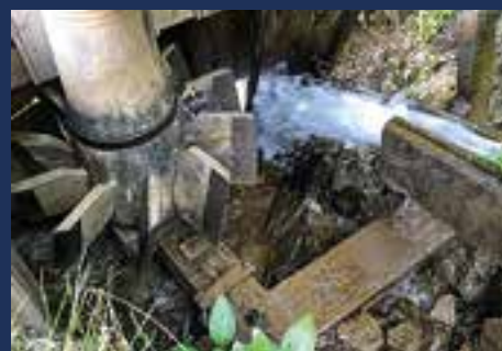
Abb. 6: Die Wasserzufuhr auf das Flotterrad mittels einer seitlich beweglichen Wasserrinne mit einer Düse
