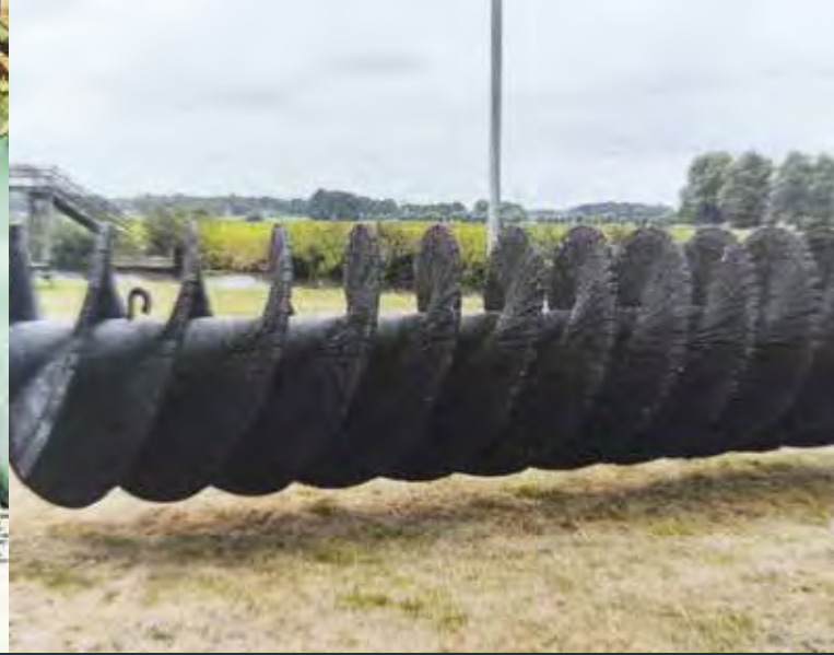
Foto einer archimedischen Schraube (Foto: Karl Frerichs)
