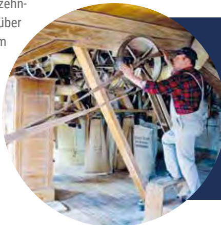
Müllermeister Gerd Graf beim Auflegen eines Treibriemens in seiner Dinkelmühle (Foto: Graf)
