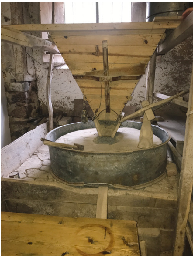
Ein Peldegang in einer bulgarischen Mühle.
