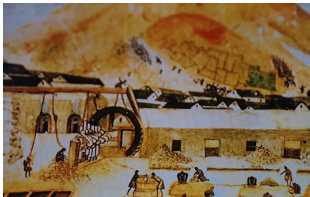
Die historische Darstellung eines Wasserrades zum Betreiben von Stampfen zur Zerkleinerung des Erzes.
