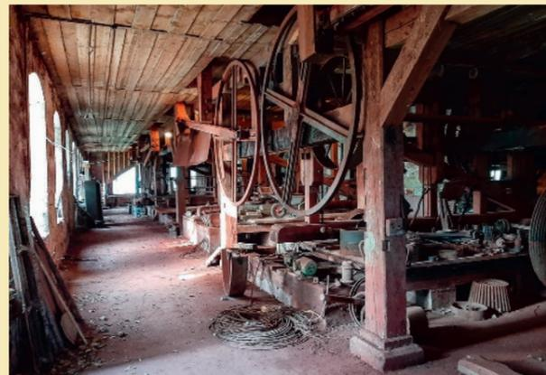
Ursprünglich als Hammerwerk und Mühle genutzt, wurde die „Alte Schleif“ in Münchshofen (Bayern) 1890 zur Glasschleife umgebaut. Bis 1953 liefen hier, von gewaltigen Wasserrädern angetrieben, rund um die Uhr auf zwei Stockwerken die hölzernen Poliertische.
