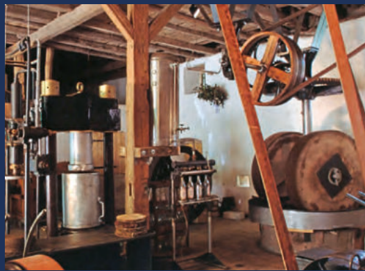
Das Innenleben der Maihinger Mühle mit Kollergang (rechts), Transmissionen usw.
