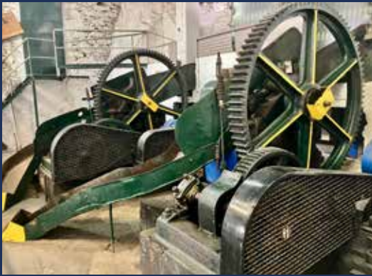
Quetsche und Rutsche für das Zuckerrohr
